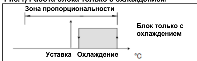
Рис. f) Работа блока только с охлаждением
